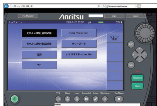
ウェブブラウザによるリモートGUI制御
